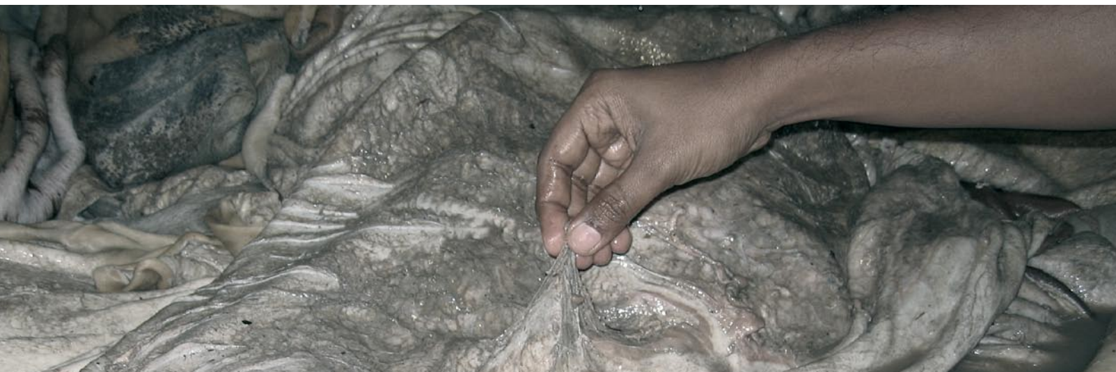
Dette kødvæv - som udgør ca. 20 % af råhudens samlede vægt - har faktisk et eftertragtet energipotentialt i form af et biobrændstof, som udnyttes i garveriets kedler til opvarmning af vand. På denne måde erstattes diesel med biobrændstof som energikilde.
