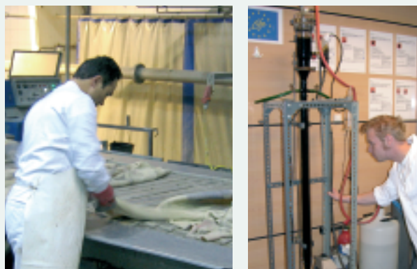
Kødstykker skæres af råhuderne (foto til venstre), og dette kødaffalds biogaspotentiale undersøges grundigt på forsøgsopstillingen i laboratoriet på garveriets Forsknings- og Udviklingscenter (foto til højre).
